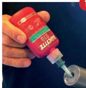
**1** Die Bolzen stets mit Loctite befestigen.
