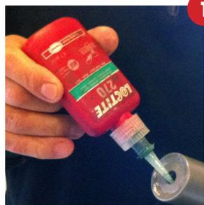
**1** Die Bolzen stets mit Loctite befestigen.
