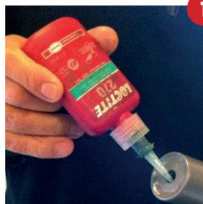
**1** Die Bolzen stets mit Loctite befestigen.
